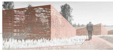
Ограждение (сталь покрашенная под кортен)
